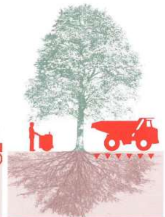
Compactage du sol
