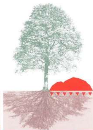
Dépôts de matériaux provisoires
