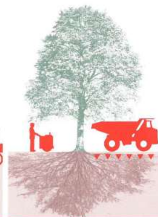
Compactage du sol
