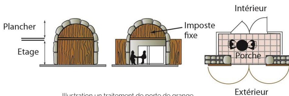
Illustration un traitement de porte de grange
